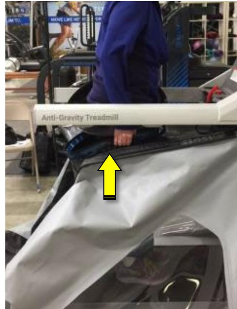
5. 继续向上拉，直到增压袋两侧吸附到扶手下方的磁铁上。
