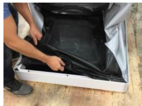
2. 将增压袋固定杆重新装到框架上。安装侧面固定杆时，插槽端先装入，插入到相邻前部固定杆的下方。拧紧前部固定杆的紧固件。
