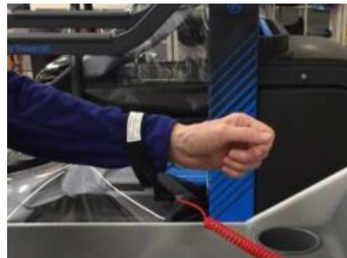
2. 将安全绳的安全磁铁直接放在控制台上标有“Emergency Stop” (紧急停止) 的圆圈指示器上；否则，反重力跑台将不会运行。
