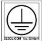
此标签位于前面板内，指示接地连接。用于零电势参考点和触电保护。
