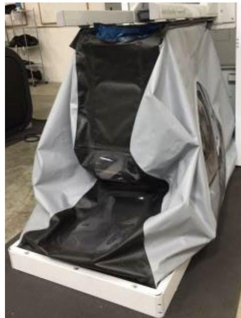
3. 找到框架上的增压袋固定杆。侧面和后部的固定杆如图所示。需要拆下这三根固定杆。从后部固定杆开始拆卸可能最轻松。
