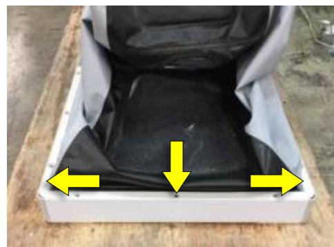
4. 使用带 10 毫米套筒的套筒扳手从紧固螺栓上拧下紧固件。
