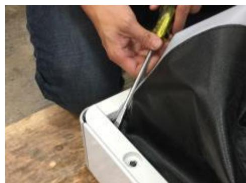
7. Vytáhněte tyče zcela z rámu a odložte je stranou s upevňovacími prvky.
