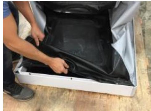
2. Vyměňte přídržné tyče vaku na rámu. Boční tyče musí být umístěny napřed pod sousední přední tyč. Utáhněte upevňovací prvek přední tyče.
