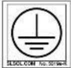
Tento štítek je umístěn na vnitřní straně předního panelu a označuje spojení se zemí.
