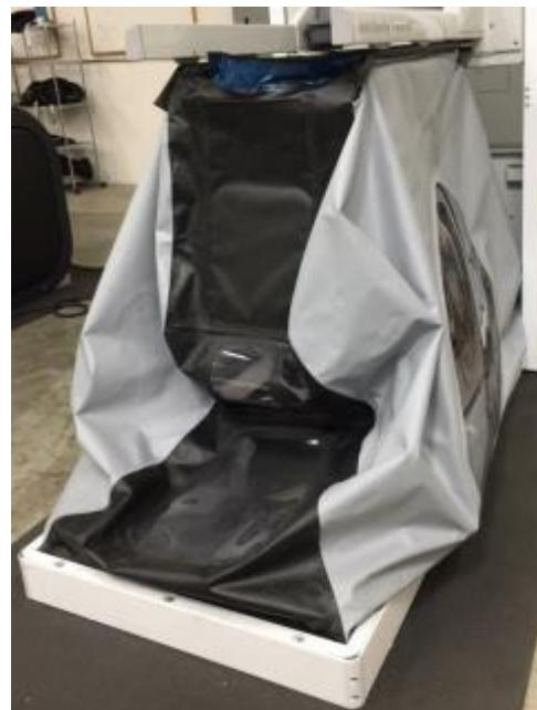
3. Vyhledejte přídržné tyče vaku na rámu. Jsou zobrazeny pruhy po stranách a vzadu. Tyto tři pruhy odstraníte. Nejjednodušší může být začít se zadní tyčí.
