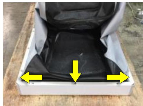
4. Pomocí nástrčného klíče s nástrčným klíčem 10 mm odšroubujte upevňovací prvky z podpěr.
